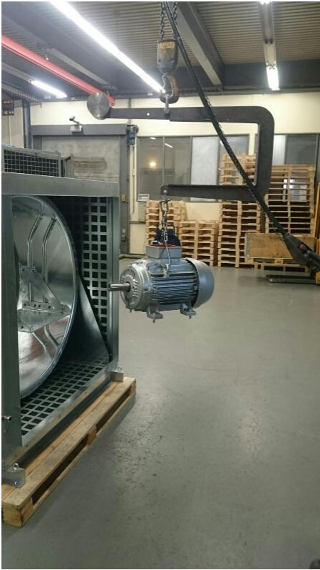
Fig 21 Sistema para elevación de motor en ventiladores axiales de camisa larga
